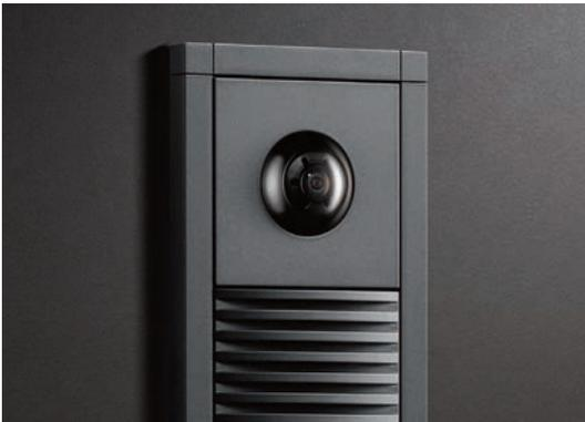
130 über Wide Dynamic Range (WDR). Die Technik wird zum Ausgleich schwieriger Lichtverhältnisse eingesetzt. Kommt es durch starkes Gegenlicht zu großen Kontrastunterschieden oder Unschärfen, gleicht die WDR-Technologie diese aus. Sie macht mehrere Aufnahmen desselben Motivs mit unterschiedlichen Belichtungen, wertet die Einzelbilder
