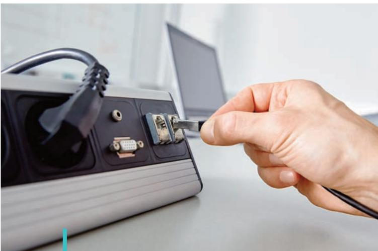
Ein minderwertiges RJ45 Patch-Kabel mit abgebrochenem Rasthaken kann keine sichere Verbindung gewährleisten.
