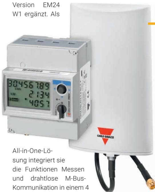
All-in-One-Lösung integriert sie die Funktionen Messen und drahtlose M-Bus-Kommunikation in einem 4 TE breiten Gehäuse. Das Gerät für DIN-Schienenmontage misst den Energieverbrauch und die Hauptversorgungsmessgrößen bei ein- und dreiphasigen Lasten oder dreiphasigen Lasten mit Neutralleiter. Für die Installation stehen ein EM24 für Direktmessung bis
